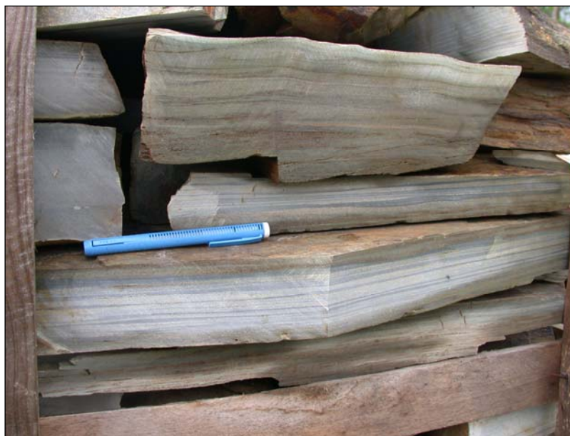
Figura 16.- “Cantera Monte da Arca”. Detalle de la metarenisca con laminaciones.
