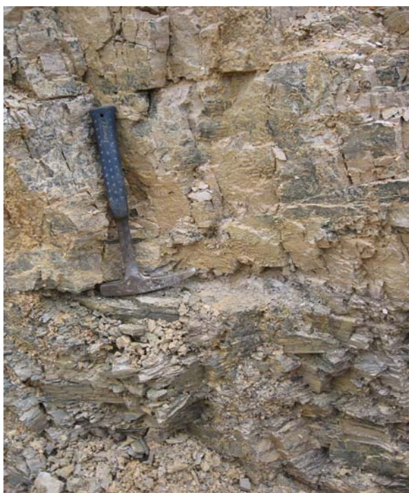
Figura 36.- Explotación “Quinta”. Detalle de la albitita rosa fresca en contacto neto con las pizarras inferiores
