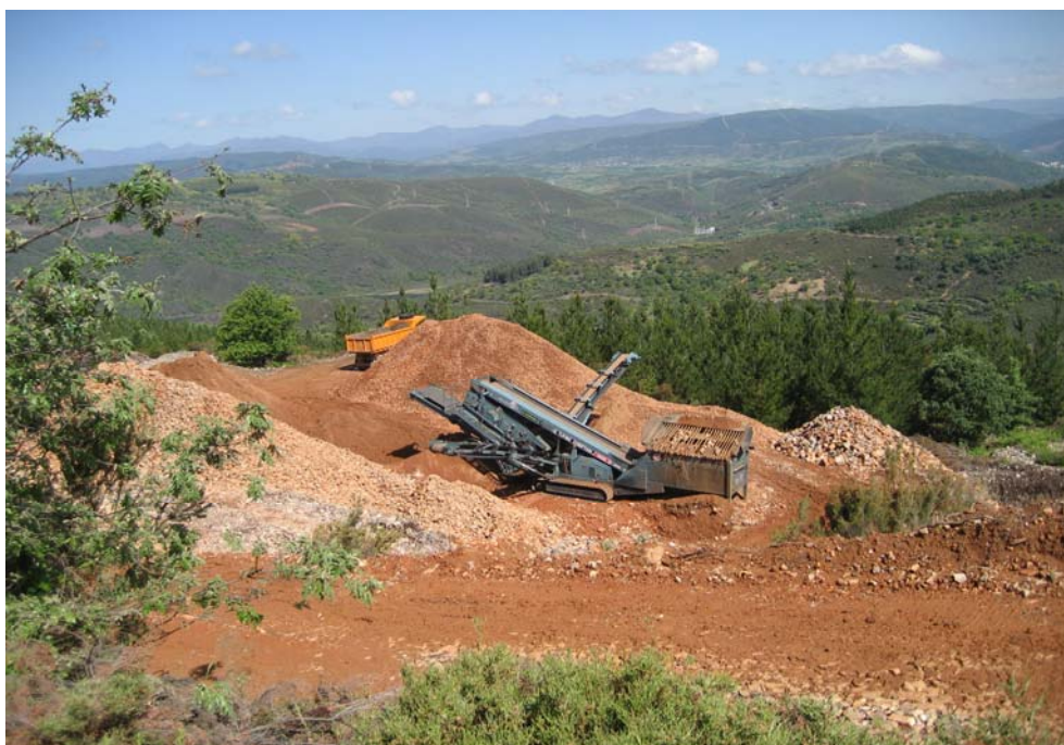
Figura 40.- Planta móvil para la separación por tamaños (los de mayor tamaño son desechados) en la cantera “Las Lomas”.
