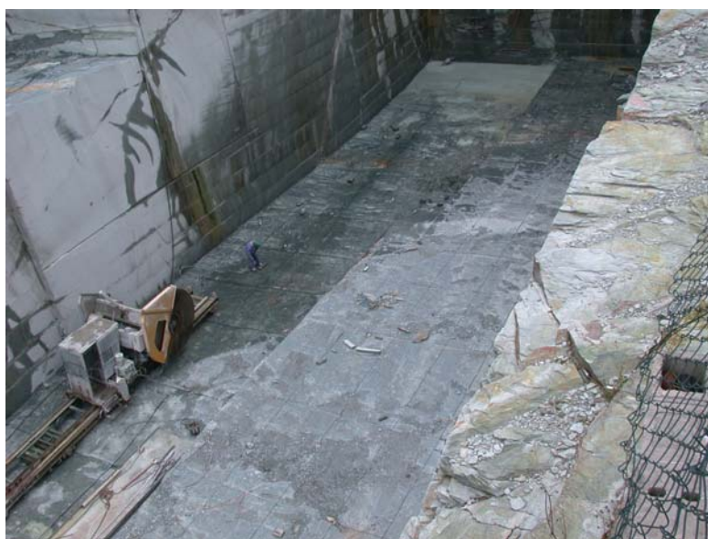
Figura 45.- Corte en mallas con sierra circular en el hueco de la explotación “Pol”.
