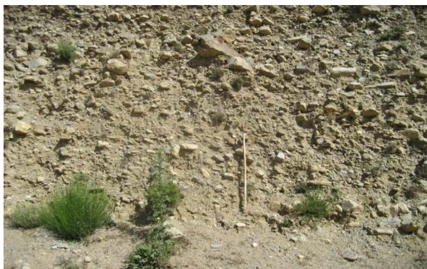
Figura 41.- Detalle de la heterometría del depósito de la explotación “Graveras de Anllares”.
