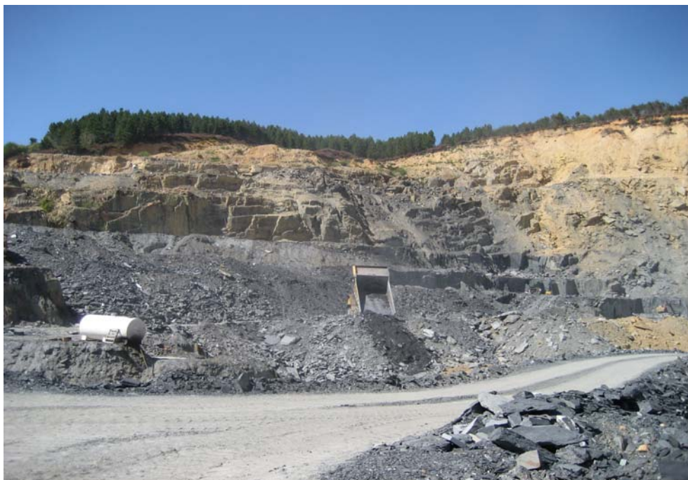
Figura 44.- Vista general del frente de la explotación “Las Cabadiñas”, con los tres bancos que presenta. En la parte superior se observan depósitos detríticos de cobertera.
