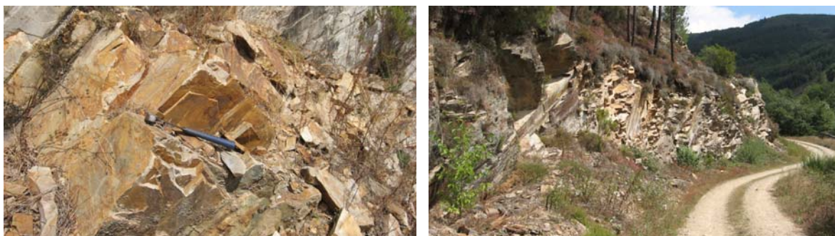
Figura 58.- Estación N° 338, indicio en Fonsagrada (Lugo), donde afloran unas cuarcitas grises muy duras y resistentes, bien estratificadas en bancos decimétricos y centimétricos, con posibilidad de ser utilizadas como roca de construcción.
