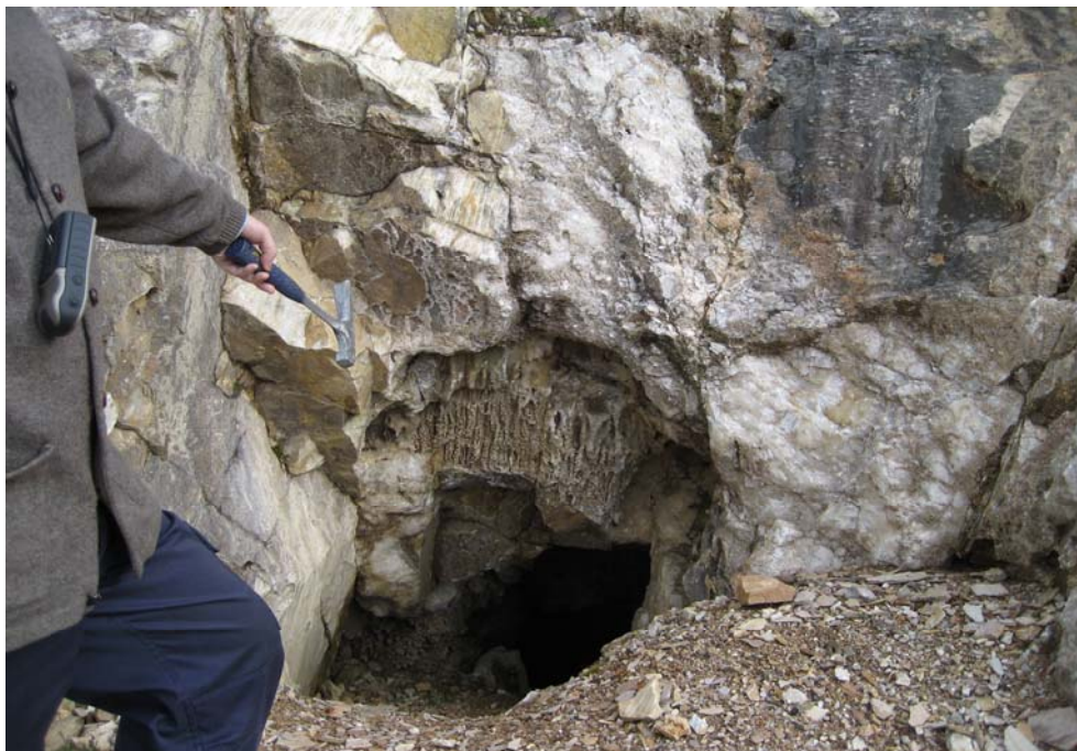
Figura 26.- Tubo kárstico formado a favor de la red de fracturación en la explotación N° 526 en Corullón.
