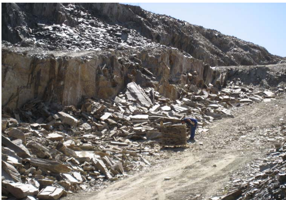
Figura 13.- Vista general de la corta “La Chana”, donde se observa el fuerte diaclasado vertical.
