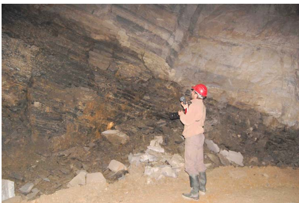
Figura 43.- Capas de caliza ricas en magnesita dentro de las galerías de explotación Impensada, de la empresa Magnesitas de Rubián, S. A.
